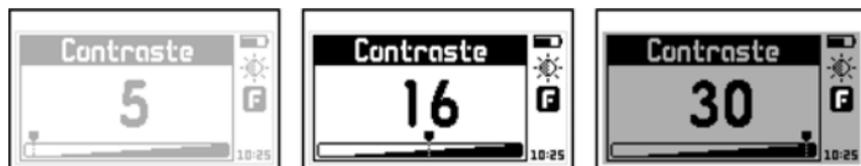
Figura 3.15: Ajuste del contraste de la pantalla
