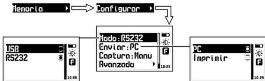
Figura 4.16: Opciones de configuración de transmisión
