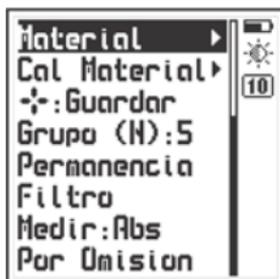
En modo UCI seleccione **Durómetro** en el menú principal del equipo para desplegar la lista de opciones de configuración de medición.
