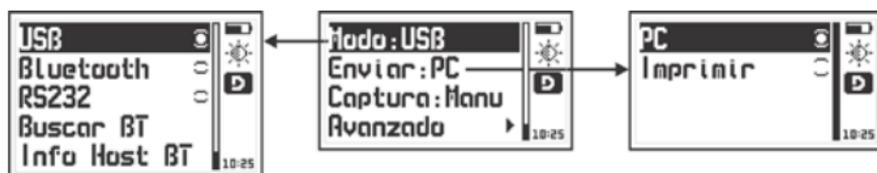
Figura 4.16: Opciones de configuración de transmisión
