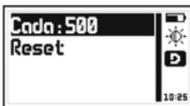
Seleccione **Cada:** para establecer el límite de la alarma (por omisión 500 impactos) y utilice **Reset** para llevar a cero el contador al reemplazar la bala o cambiar el dispositivo.
