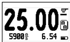
Retención de ultimo valor activada
